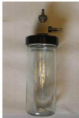
Photo 3 : Vials de prélèvement d'air équipé du SPME-adapter
