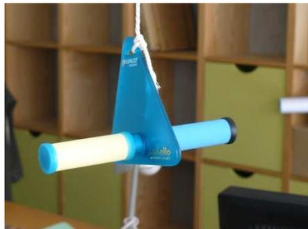
*Photo 1 : échantillonnage passif de l'air intérieur sur tubes Radiello®*
